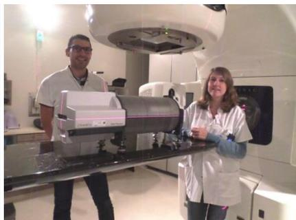
Les physiciens devant le fantôme 3D : il permet de s'assurer que l'accélérateur est capable de réaliser le traitement planifié.
